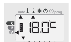
Fil pilote = Éco - 1 Confort - 1°C
